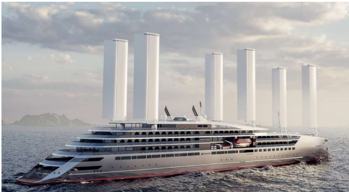
Image 3D du projet Swap2Zero : Dans le cadre de l'appel d'offre, 2 systèmes de propulsion vélique sont en cours d'étude. Ici avec la technologie Ayro « Oceanwings® ».
